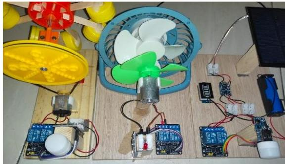
**Gambar 9.** Alat Peraga Energi Terbarukan Terintegrasi IoT
