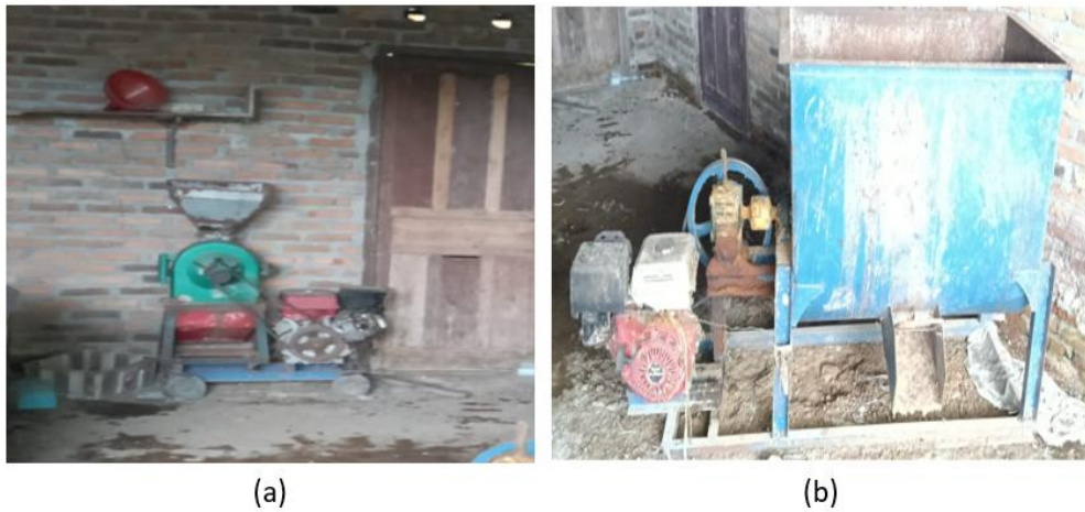
Gambar 1. (a) Mesin yang digunakan peternak bebek mencacah jagung. (b) Mesin untuk mengaduk pakan dalam bentuk serbuk
