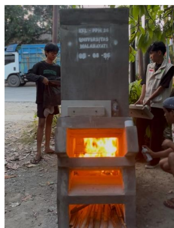
Gambar 3. Demonstrasi pembakaran biomassa menggunakan rocket stove .
