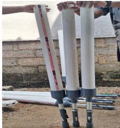
Gambar 1. Alat Penabur Pupuk Sederhana dari Pipa Paralon
