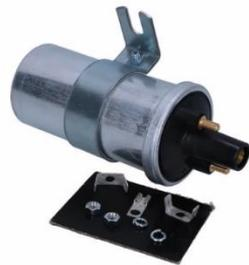
Koil pengapian berfungsi merubah arus listrik 12V yang diterima dari baterai menjadi tegangan tinggi (10KV atau lebih) untuk menghasilkan loncatan bunga api yang kuat pada celah busi.
